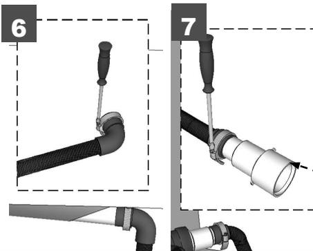
6. Ablaufanschluss an Schlauchkasten anschließen.
