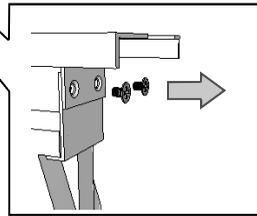
3. Trägerplatte mit Schlauchkasten aus Rahmen herausheben und die Verschraubung des Schlauchkastens lösen.
