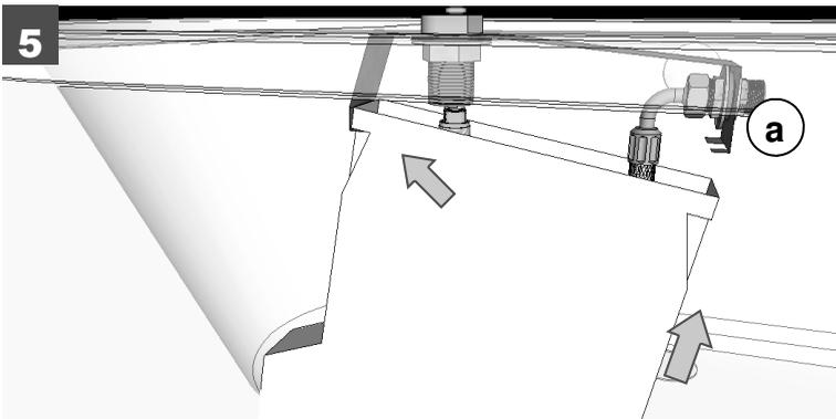
5. Schlauchkasten einsetzen und Wasseranschluss herstellen.
