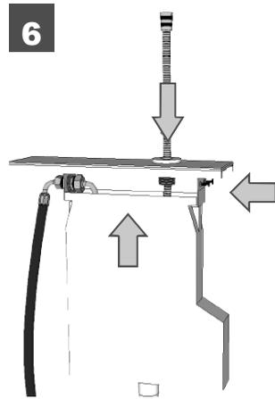
**6.** Schlauchkasten einsetzen, verschrauben und Brauseschlauch einschieben.
