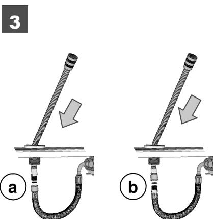
3. Brauseschlauch einführen und mit Panzerschlauch verbinden.
