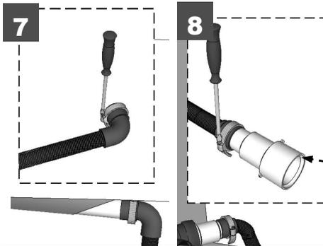
**7.** Ablaufanschluss an Schlauchkasten anschließen.
