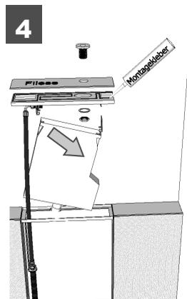
4. Schlauchkasten entfernen. Fliesen auf der Trägerplatte mit einem aushärtenden Kleber aufbringen. Wannranddurchführung einsetzen und festziehen.
