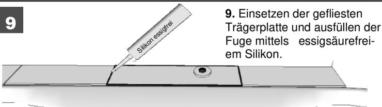
**9.** Einsetzen der gefliesten Trägerplatte und ausfüllen der Fuge mittels essigsäurefreiem Silikon.
