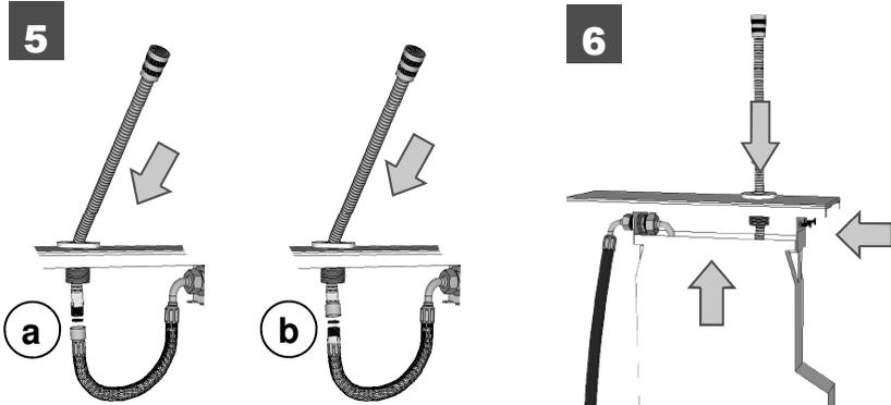
**5.** Brauseschlauch einführen und mit Panzerschlauch verbinden.
